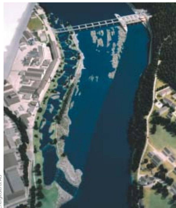
Modell des Fischpasses am Wasserkraftwerk Rheinfelden (Hochrhein)
