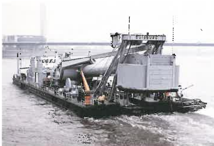
Fig. 2 le « Carl Straat », bateau équipé d'une cloche à plongeurs
