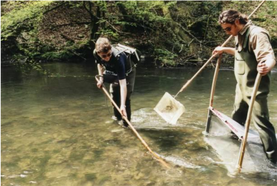
Photo: St. Staas, utilisation combinée d'un filet dérivant et d'un appareil de pêche électrique pour la reconnaissance du frai de salmonidés au printemps.
