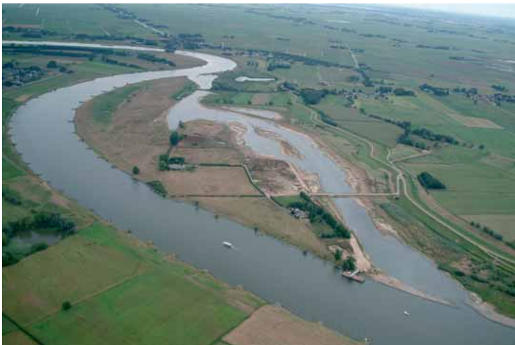
Figure 3 : Réalisation sur l'IJssel d'un système de bras latéraux conforme à l'état de référence (photo : B. Boekhoven)
