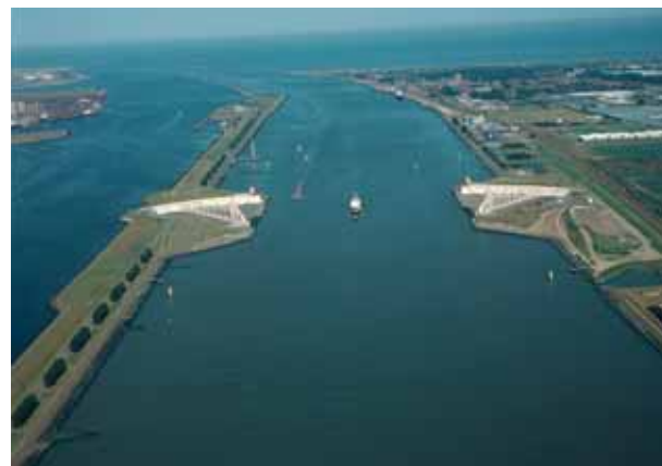
La Maeslantkering : mesure de protection contre les inondations sur la seule ouverture du Rhin sur la mer (photo : RWS Zuid-Holland)
