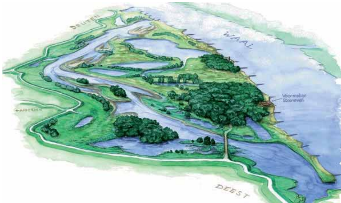
Figure 2 : Représentation schématique d'un système de bras latéraux conforme à l'état de référence (RWS RIZA)
