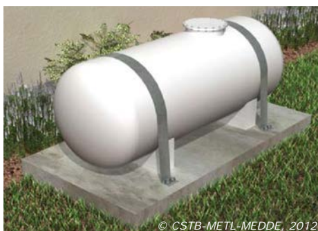
Exemple d'ancrage d'un réservoir à mazout
