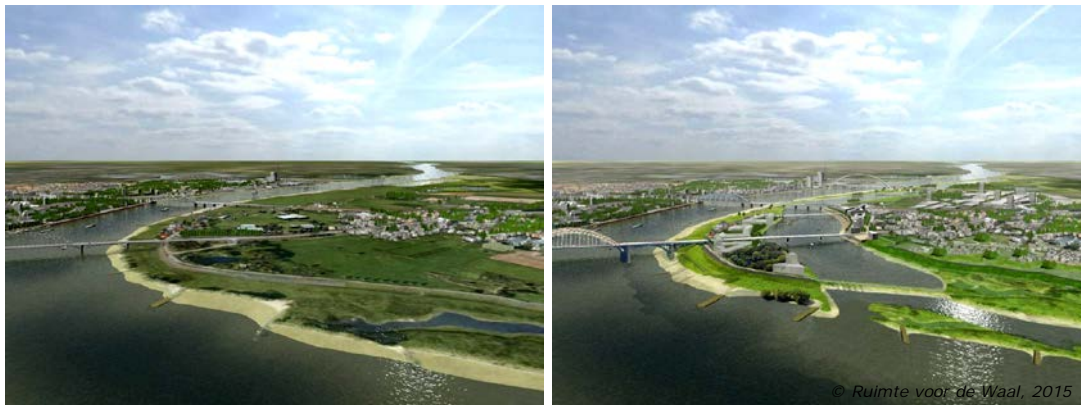
Voorbeeld van rivierverruimende maatregelen bij Lent/Nijmegen (Nederland). Dijkverlegging Lent, links: huidige situatie, recht: toekomstige situatie (programma “Ruimte voor de rivier”, project “Ruimte voor de Waal” http://www.ruimtevoordewaal.nl / ©: Ruimte voor de Waal)
