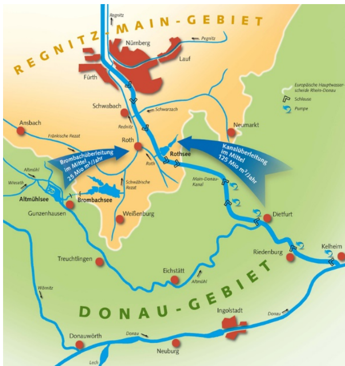
Figuur 4: Systeem voor de toevoer van water vanuit de Donau naar de Main (StMUV, 2011)
